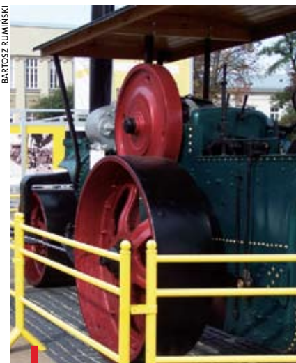
Walec parowy Marshall, trzykołowy, napędzany maszyną parową dwucylindrową z kotłem poziwym
